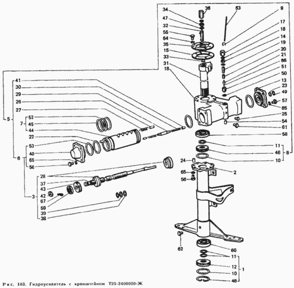
Рис. 103. Гидроусилитель с кронштейном Т25-3400020-Ж
