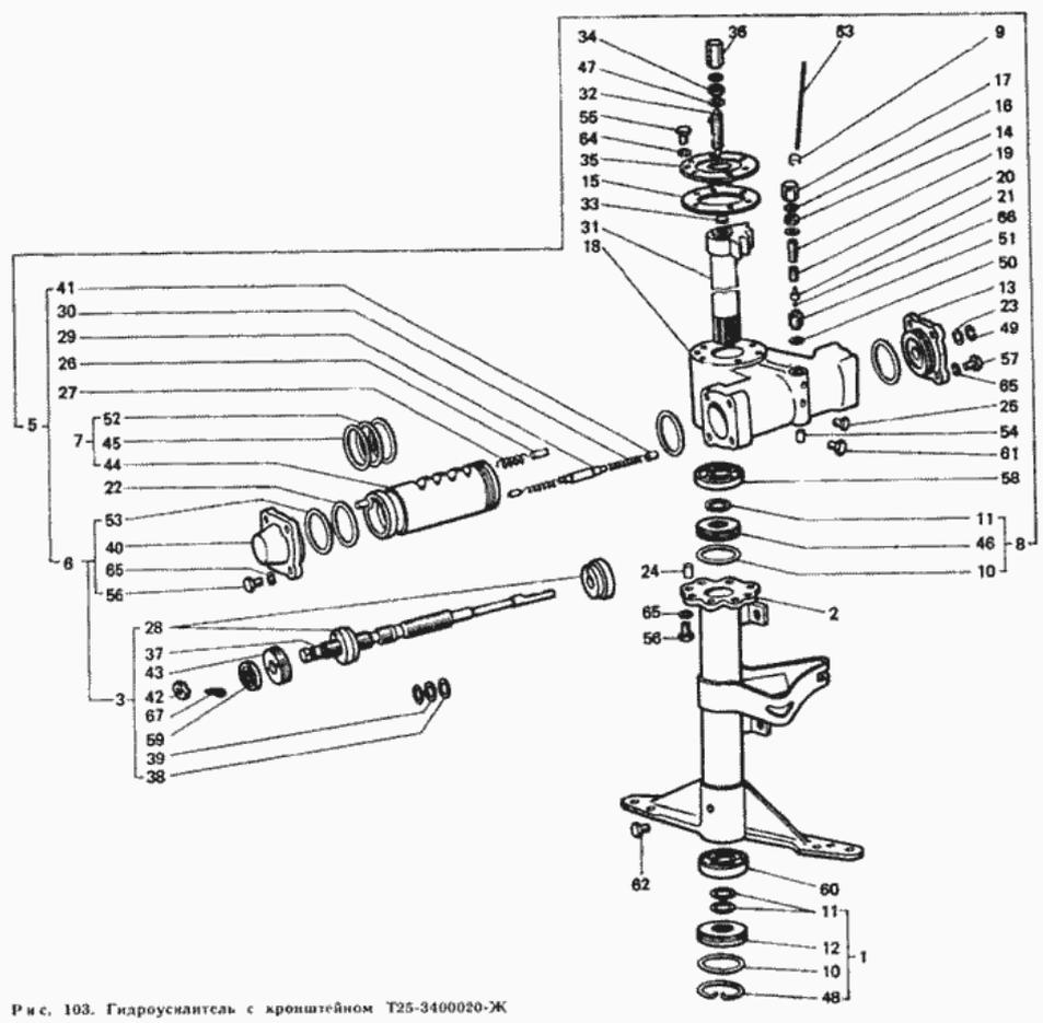
Рис. 103. Гидроусилитель с кронштейном Т25-3400020-Ж
